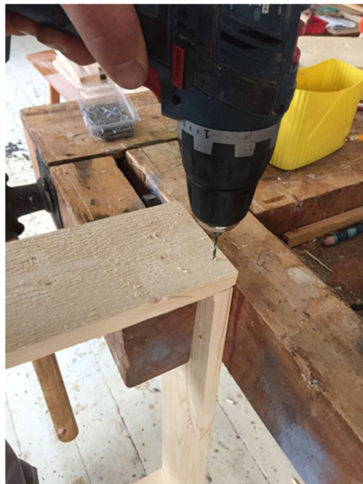
Bore små hull før spikkring
