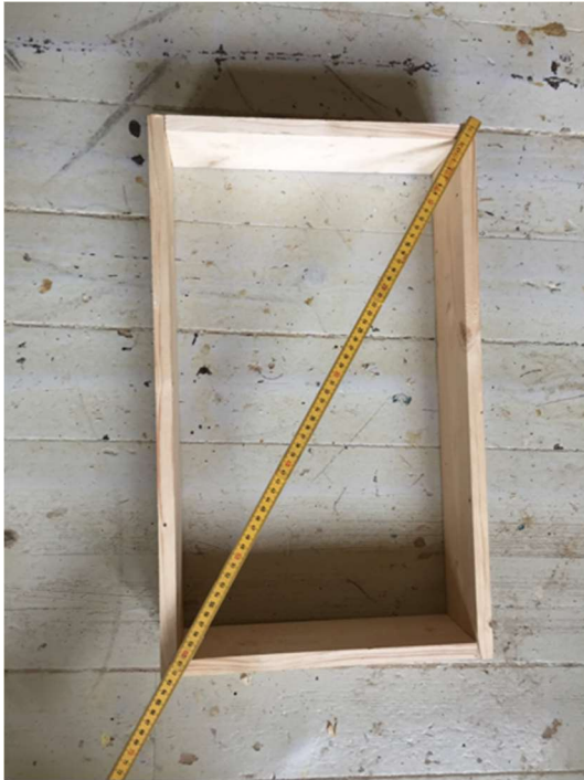
Måling av diagonal
